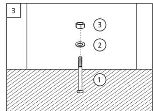
Stellen Sie den Briefkasten anschließend direkt auf die frisch gegessene Platte. Führen Sie dabei den Bolzen (1) durch die Bohrung in der Bodenplatte des Briefkastens. Schrauben Sie den Briefkasten mit Mutter (3) und Unterlegscheibe (2) fest. / Place the mailbox directly at the newly poured foundation plate. Lead the bolt (1) through the hole in the base plate of the mailbox. Screw tight the mailbox with a nut (3) and a washer (2).
