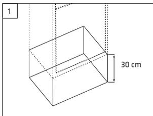
Heben Sie ein 30 cm tiefes Loch aus, das ungefähr so groß ist wie der Boden des Briefkastens. Füllen Sie dieses Loch mit Beton und glätten Sie diesen ebenerdig. / Dig a 30 cm deep hole which is approx. as big as the base plate of the mailbox. Fill the hole with concrete and even it out at ground level.
