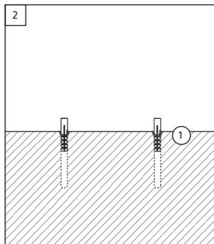
Rücken Sie den Briefkasten zur Seite, setzen Sie die Bohrungen und stecken Sie die Dübel (1) in die Bohrungen. / Move over the mailbox and set the drilling holes. Afterwards, insert the plug (1) into the holes.
