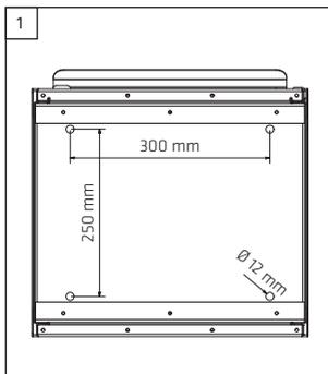
Stellen Sie den Briefkasten auf den gewünschten Platz und markieren Sie die Bohrlöcher von innen, alternativ kann auch das abgebildete Bohrbild übertragen werden. / Place the mailbox on the intended location and mark the drilling holes from the inside. Alternatively, it is possible to copy the shown drilling template on the ground.
