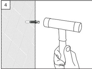
**Dübel (2) in die gebohrten Löcher stecken /**
